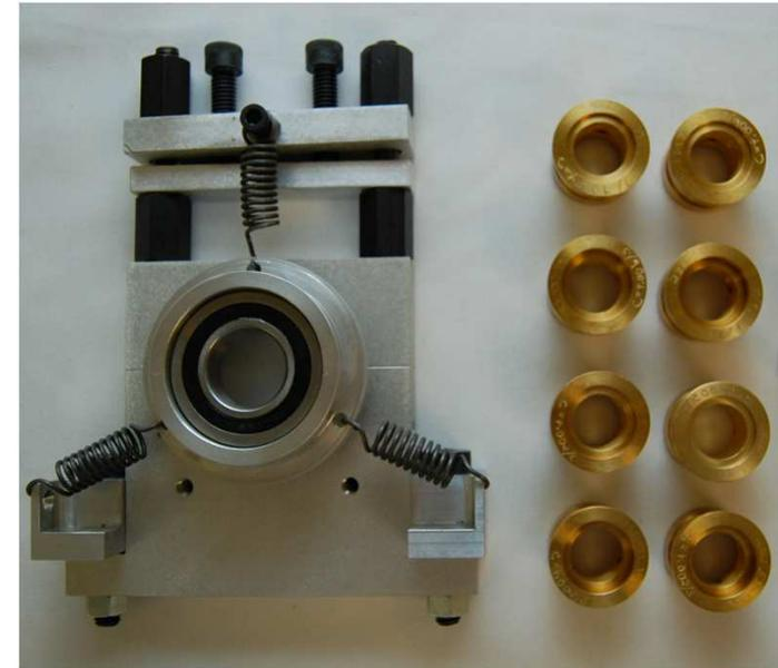
*Ce kit contient 4 paires de coussinets pour faire varier les jeux de paliers, deux coussinets avec une forme légèrement elliptique afin d'éviter les phénomènes d'instabilité de whip/whirl et un appareil de centrage de l'arbre.*
