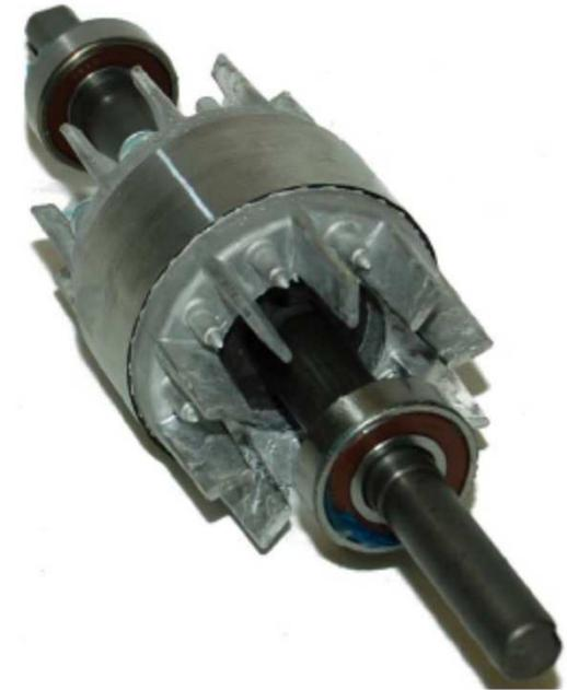
*Ce kit contient un moteur équipé d'un roulement avec un défaut de bague interne et un roulement avec un défaut de bague externe. L'utilisateur peut spécifier les types de défauts désirés.*
