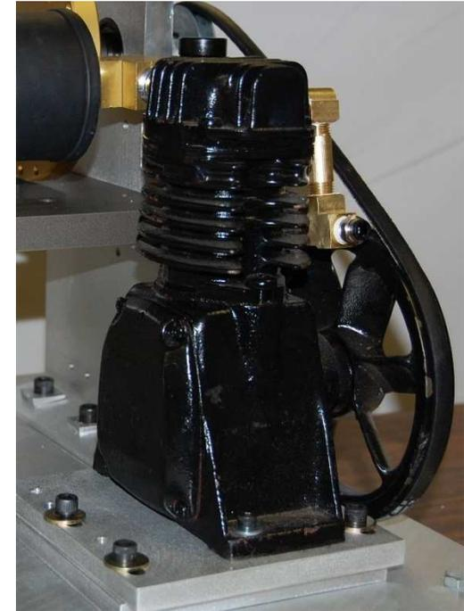
*Ce kit contient un compresseur de 373W avec une valve fuyarde, un filtre d'aspiration bloqué, un défaut d'ouverture de valve de refoulement et un embiellage surdimensionné.*
