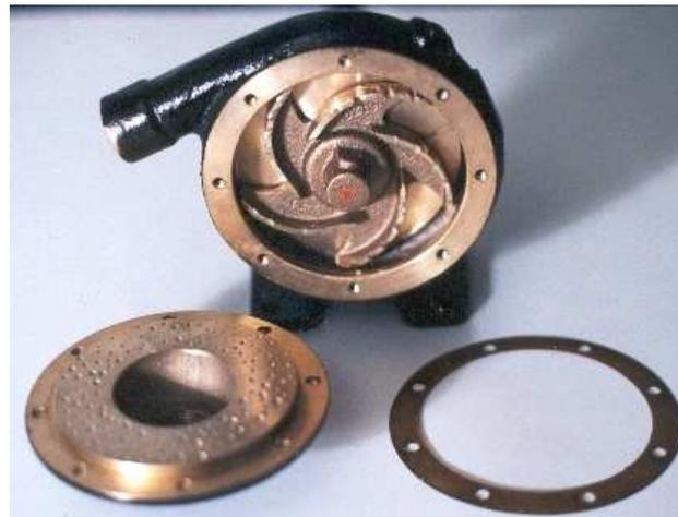
*Ce kit contient une pompe centrifuge usée qui permet de simuler le phénomène de cavitation.*
