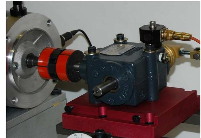
*Ce kit contient un bloc de montage pour connecter le réducteur directement en sortie du moteur.*
