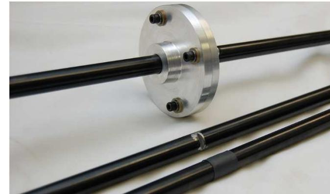
*Ce kit contient trois arbres : un arbre comprenant une bride qui simule une fissuration, un arbre avec une petite fissuration et un arbre avec une fissuration profonde en V.*
