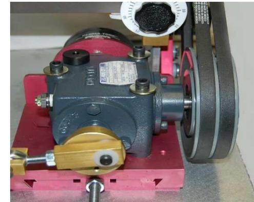
*Ce kit contient deux courroies trapézoïdales, deux poulies à double rainures, d'un tendeur, un réducteur lubrifié à l'huile avec des engrenages coniques, des roulements coniques et un frein magnétique réglable manuellement.*
