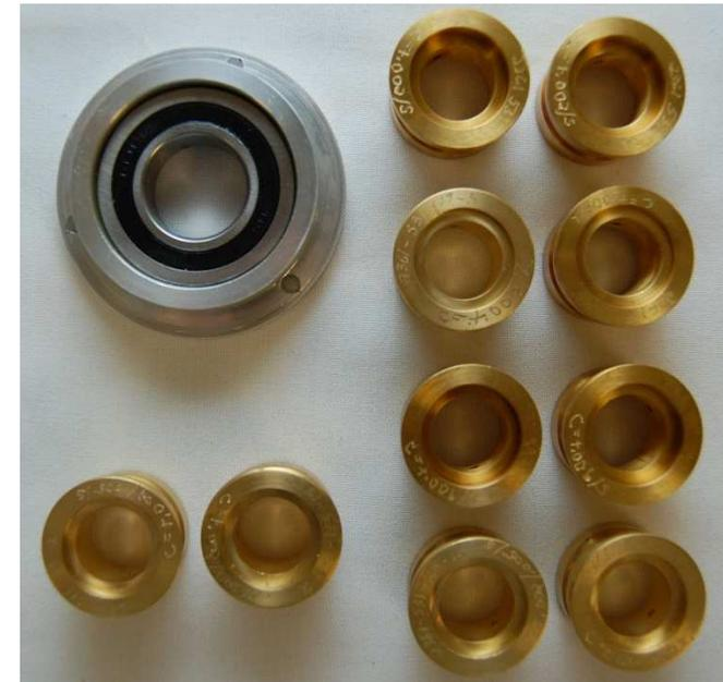
*Ce kit contient 4 paires de coussinets pour faire varier les jeux de paliers, deux coussinets avec une forme légèrement elliptique afin d'éviter les phénomènes d'instabilité de whip/whirl et un appareil de centrage de l'arbre.*
