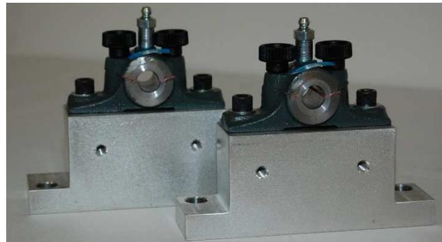
*Ce kit contient deux paliers lisses à graisse, les accessoires de fixation ainsi que des jeux de cales en plastique.*
