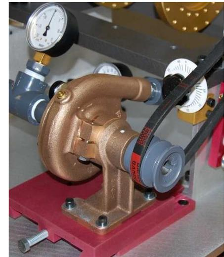
*Ce kit contient une pompe centrifuge à un étage, deux manomètres, un débitmètre, un réservoir, un couvercle en plexiglas, des valves, une poulie et tous les accessoires nécessaires pour installer ce kit sur le simulateur.*
