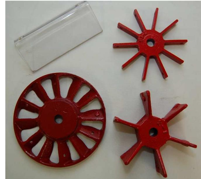
*Ce kit contient un ventilateur à 6 pales, un ventilateur à 10 pales, un ventilateur à 12 pales et une obstruction axiale de ventilateur.*
