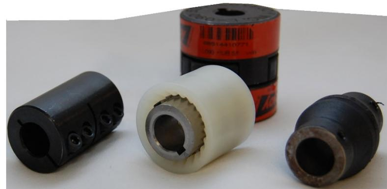
*Ce kit contient un accouplement à denture, un accouplement à deux inserts, un accouplement élastique et un accouplement rigide en acier.*
