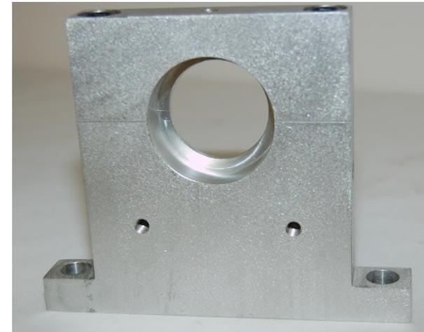
*Ce kit contient un palier de diamètre intérieur 5/8" avec un défaut géométrique.*
