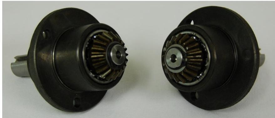
*Ce kit contient un pignon avec un dent manquante et un pignon avec une dent ébréchée.*
