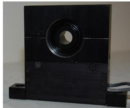
*Ce kit contient un capteur qui mesure simultanément la force verticale et horizontale, ainsi qu'un conditionneur de signal adapté.*
